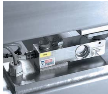
6. Containershuttle als Dosierwagen mit integrierter Waage
